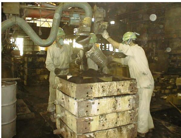
3) 溶鋼を電気炉から取鍋に注入する際に多量の粉塵、ヒュームが発生する。
