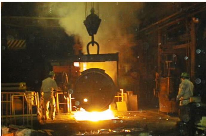
5) 解杵作業は機械で行うが、写真のように小さいものは鑄型をハンマーで打っていた。その際多量の粉じんが発生する。ここでも白く丸く写った粉じんが見える。
